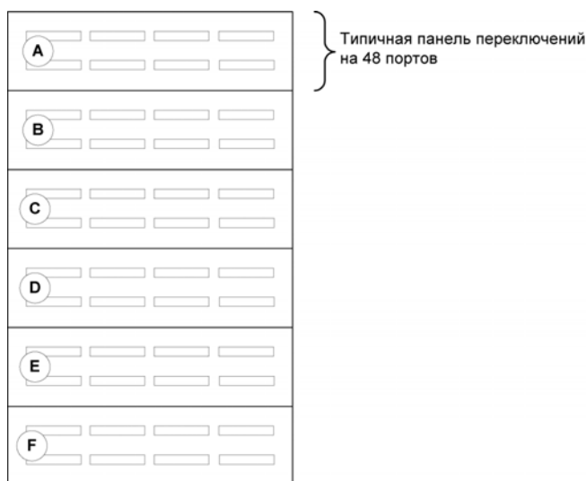
16 Рис. 13. Пример идентификационной схемы для панели переключений медной 17 кабельной разводки
